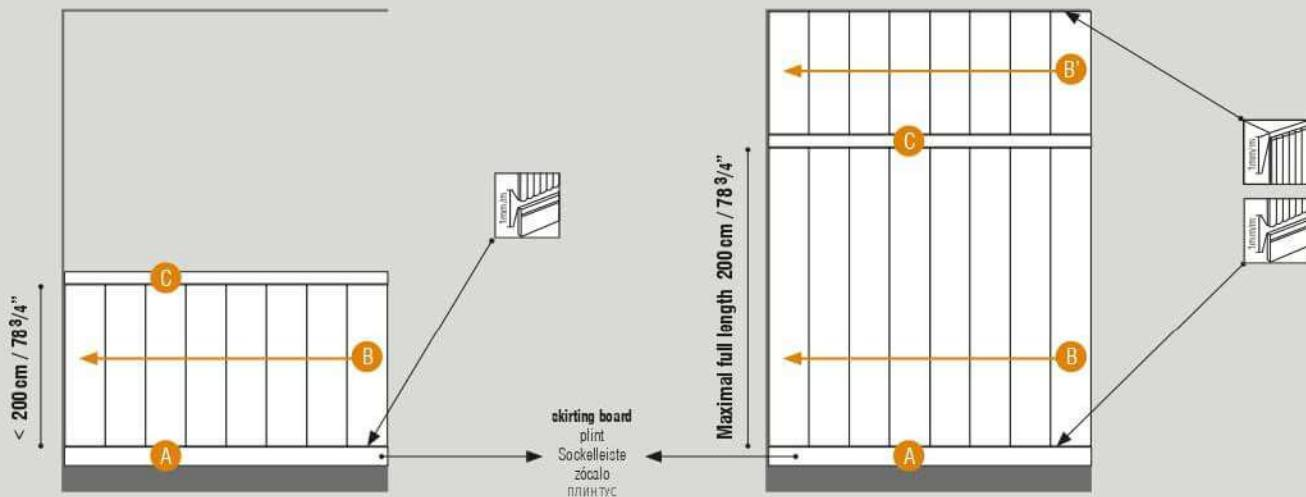
**Always install a skirting board** | Installeer altijd een plint | Installer toujours une plinthe | Immer eine Sockelleiste anbringen | Instalar siempre un zócalo | Обязательно устанавливайте плинтус
