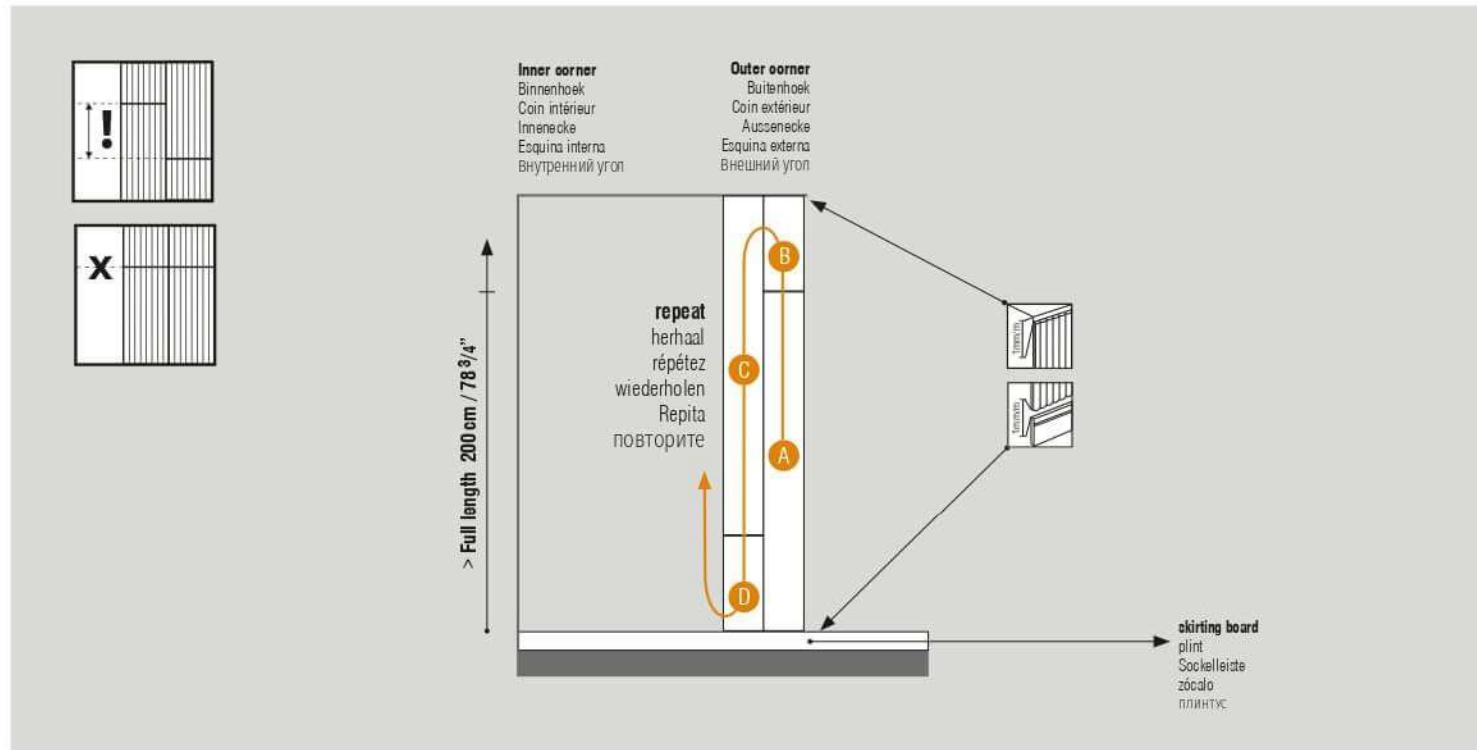
**Always install a skirting board** | Installeer altijd een plint | Installer toujours une plinthe | Immer eine Sockelleiste anbringen | Instalar siempre un zócalo | Обязательно устанавливайте плинтус
